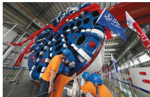
▲为了适应福州地铁4号线复杂的地质条件和极硬岩施工,分公司盾构中心与研发单位通力合作,福建省首台暨中交集团、三航局首台TBM-EPB双模盾构机——“三航盾6”应运而生。(付群扬)
